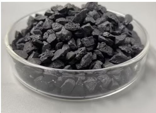
Рисунок 2 — Железный катализатор, используемый в реакции Габера–Боша
