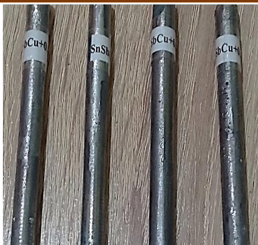
Рисунок 1 - Образцы SnSb11Cu6 с добавками лития
