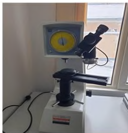
Расми 1 – Нақшаи озмоиши сахтӣ тибқи усули Бринелл (ГОСТ 9012–59) (а) ва дастгоҳи ченкунии сахтӣ MODEL HBRV-187.5D (б).
